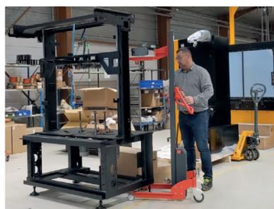
L'atelier de maintenance NSE situé au sein des écoles militaires de Draguignan a fait **l'acquisition d'un portique de levage pour améliorer les conditions de travail** lors des opérations de démontage, nettoyage, maintenance et remontage des pièces d'artillerie lourde.
