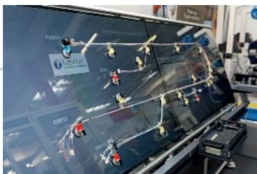
Grâce au plan de relance dont NSE a bénéficié, **des tables de câblages interactives** ont pu être mises en place. La table de câblage interactive remplace les plans papiers par un affichage dynamique des plans et des instructions d'assemblage.
